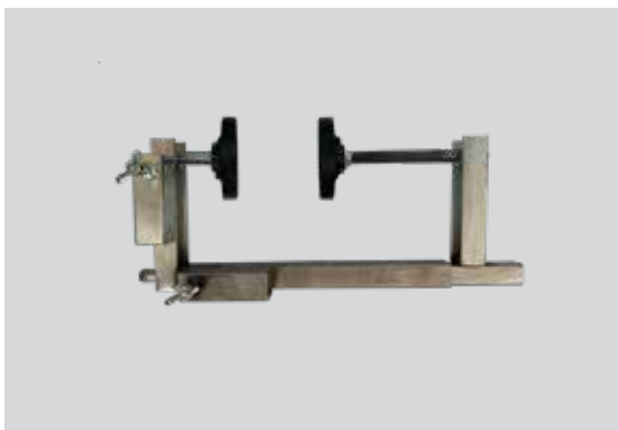
Morsetto in configurazione standard chiusa: elementi telescopici completamente compressi, distanza minima tra i punti di serraggio.
