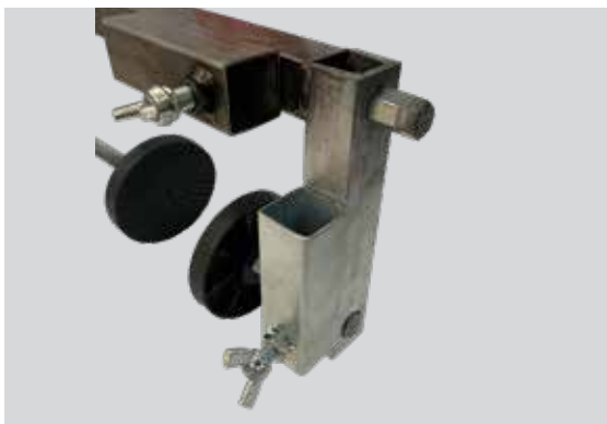
Basette bloccanti strette al massimo, con barra filettata completamente avvitata nell'alloggio per garantire la minima escursione.
